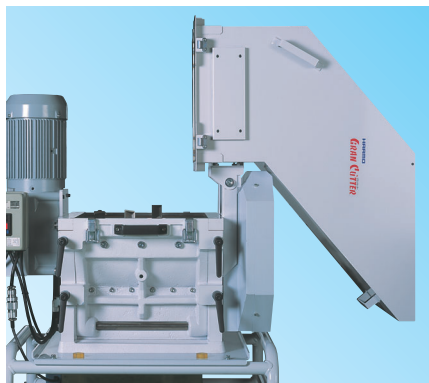
ホッパー開閉はヒンジ付きで安全に。 料斗开启配备铰链连接,提高安全系数。
