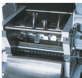
プレス刃は8m/m標準。オプションとして6m/mを用意しました。(OPはSタイプを除く) 压力刀8m/m为标准型。同时具备6m/m非标型可供选购。(选购件S机型除外)
