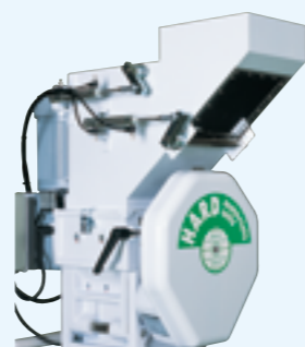
飛散防止シャッター付ホッパー ・この写真は二段シャッターです。 ・その他には一段シャッター、観音開きのシャッター、スライドシャッターなどがあります。
